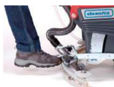
Relevage et descente du suceur avec le pied. Changement des lamelles sans outil
